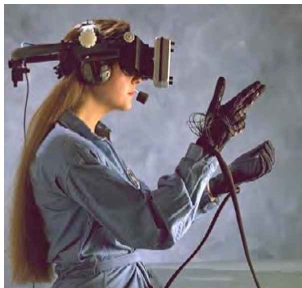
Equipamento de realidade virtual. Ecrã montado na cabeça e luvas com fio (cortesia da NASA)
